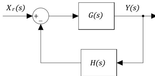
Figura 10.1: Sistema realimentado.
