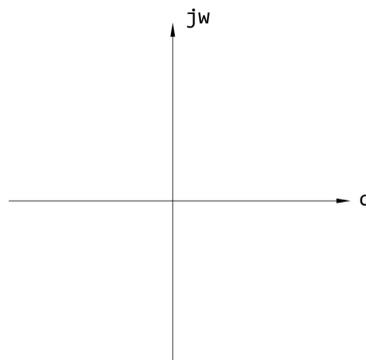
Figura 3.1: Plano  $s$  compuesta por el eje real  $\sigma$  y un eje imaginario  $j\omega$ .
